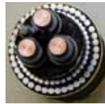
◀実物の海底ケーブルの断面
