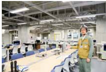
緊急時対策所：現在も新規制基準への適合性審査に係る一部の工事は継続しているが、建物本体は2017年3月に完成。建物は鉄筋コンクリート製で、壁や天井の厚さを最大2mまで厚くすることにより、緊急時対策所外の放射線に対する遮へい性を高めている
