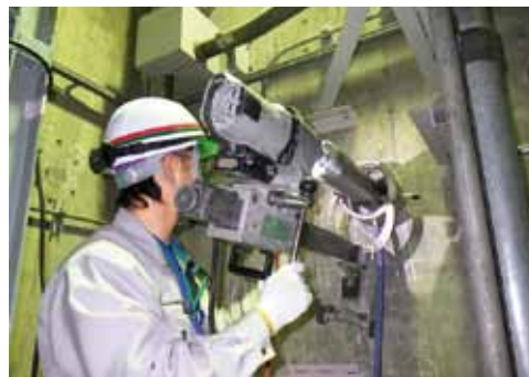
【原子炉圧力容器材料およびコンクリートの健全性評価】1号機実機から構造物の一部を採取し、原子炉の運転や経年による材料特性の変化を調査・研究している。写真はコンクリート試験片の採取の様子。
