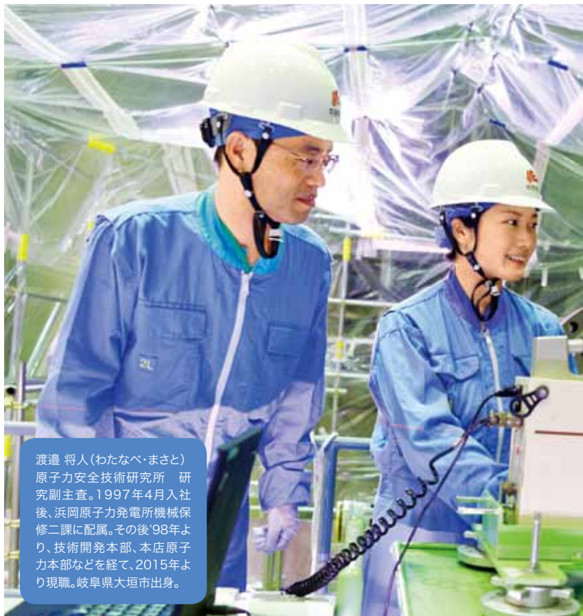
浜岡原子力発電所廃棄物管理課のメンバーにクリアランス測定技術を伝えるため、放射線管理区域で防護服を着用し、タービン軸の放射線レベル測定に立ち会う。
