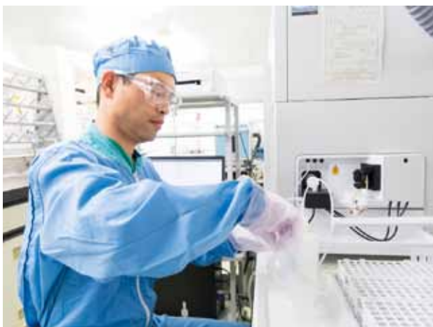
管理区域内に設置した分析室で、放射化されやすい元素の濃度（例：コバルト）を測定している様子。放射能濃度を計算で求める際の入力データとなる。
