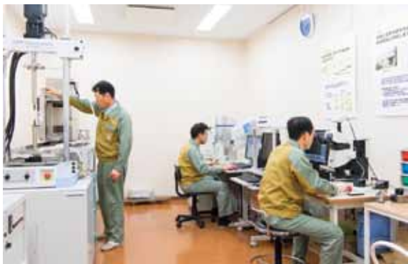
原子力安全技術研究所 実験棟。材料強度試験装置(左)、電子顕微鏡(中央)、光学顕微鏡(右)を使用して、材料の劣化メカニズムの解明などに関する研究を行っている。
