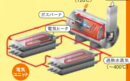
開発品「E&Gハイブリッド式過熱水蒸気発生器」の構造図解
