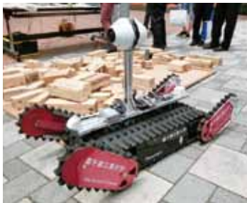
「ローズマリー」:原子力発電所内の探査を行うために開発されたロボット。その開発には、「クインズ」運用によって得られた多くの知見が生かされている。
