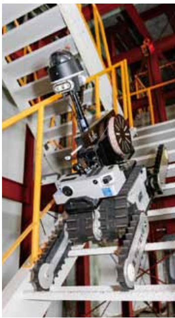
「サクラ1号」: 「クインズ」や「ローズマリー」の知見を生かした最新型の災害対応ロボット。福島第一原子力発電所の建屋内を再現した試験場（千葉工業大学新習志野キャンパス内）でテストが繰り返された。現場の要望に応え、災害時の原子力発電所や水中等過酷な環境下でも作業が可能。
