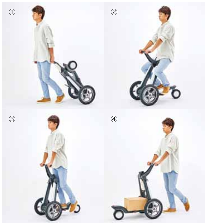
「ILY-A」:目的に応じて4モードに変形する。①持ち運ぶときの「キャリーモード」、②自動停止機能と人工知能を搭載した電動3輪車の「ビークルモード」、③立ち乗りができる「キックスケータモード」、④パワーアシストがついた手押し車の「カートモード」。世代を超えたニーズに 대응する「未来の足」をカタチにした。(※ILY及びILY-Aはアイシン精機株式会社の登録商標)
