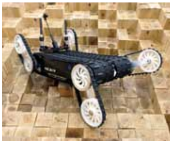
「クインズ」:放射能汚染を含めた災害時に、人に代わって現場に進入し、状況調査を行うことを目的に開発されたレスキューロボット。コンパクトなクローラー(ベルト式の車輪)なので原子炉建屋内の斜度40度、幅90cmの狭い階段の昇降も可能。建屋内部は分厚いコンクリートで無線が使えないため、有線ケーブルの巻き取り装置も搭載。2011年の福島第一原子力発電所の内部探査にも活用された。また浜岡原子力発電所にて試験も行われた。
