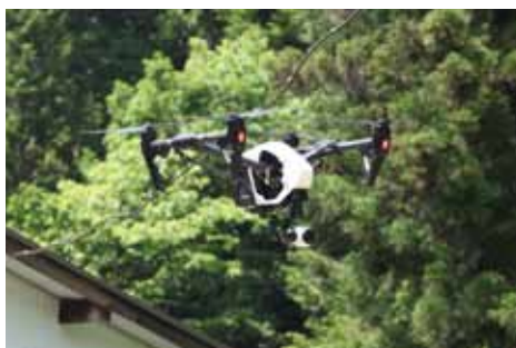
被災地の巡視に初めてマルチコプター（ドローン）を活用。停電箇所の特定、被害状況の確認を支援。
